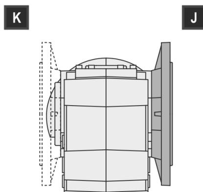
Se non diversamente specificato il riduttore viene fornito con l'accessorio in pos. J riferito alla posizione di piazzamento B3/B5.
